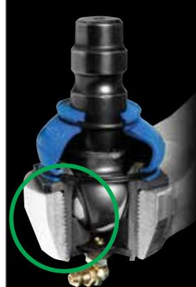
Le concept innovateur de joint à rotule fileté permet d'offrir des roulements en métal fritté graissés améliorés à l'intérieur des bras de suspension monoblocs en aluminium.
